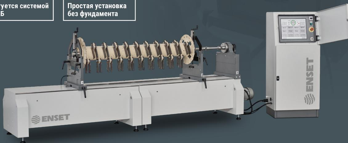
Станок ДБР-900К оптимизирован для эффективной балансировки большинства типовых роторов сельскохозяйственных машин (посевных средств и средств сбора
