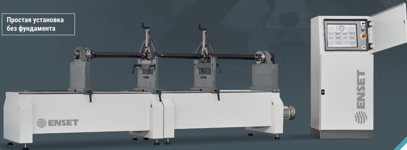
Балансировка – финишная операция в ремонте карданного вала. Она же является и очень важной, ведь вибрация при некачественно проведенной балансировке не только снижает ресурс узлов в 10 – 20 раз, но и создает сильнейший
