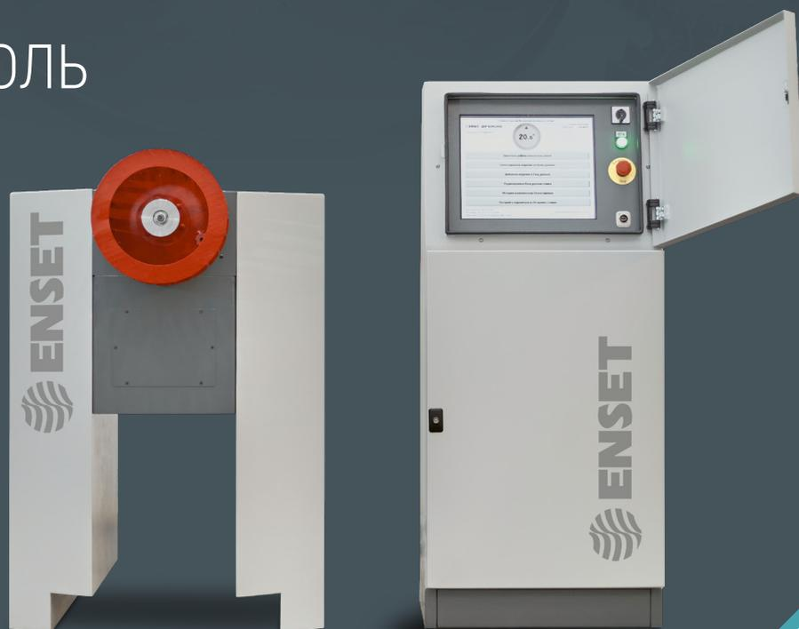
Станок ДБР КОНСОЛЬ предназначен для сверхточной балансировки весьма широкого спектра изделий – от дискообразных роторов, рабочих колес и крыльчаток до автомобильных колес. В программное обеспечение системы измерений станка интегрирован специальный режим корректировки дисбаланса на конструктивных углах – станок покажет, на какие лопасти вешать груз (или удалить материал), оператору не нужно выполнять самостоятельно сложные вычисления.
