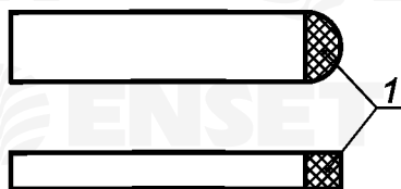
Рисунок С.9 — Шпоночная канавка 1) вала, прорезанная концевой фрезой
